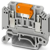
Messertrennklemme, Nennspannung: 400 V, Nennstrom: 16 A, Anschlussart: Schraubanschluss, Bemessungsquerschnitt: 2,5 mm<sup>2</sup>, Querschnitt: 0,2 mm<sup>2</sup> - 4 mm<sup>2</sup>, Montage: NS 35/7,5, NS 35/15, NS 32, Farbe: grau
