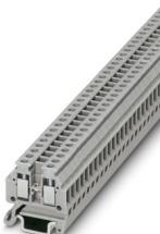
Mikroklemme, Nennspannung: 400 V, Nennstrom: 17,5 A, Anzahl der Anschlüsse: 2, Anschlussart: Schraubanschluss, Bemessungsquerschnitt: 1,5 mm<sup>2</sup>, Querschnitt: 0,14 mm<sup>2</sup> - 1,5 mm<sup>2</sup>, Montageart: NS 15, Farbe: grau
