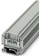
Durchgangsklemme, mit Prüfbuchsen-schrauben zur Aufnahme von Prüfsteckern, Nennspannung: 400 V, Nennstrom: 16 A, Anzahl der Anschlüsse: 2, Anschlussart: Schraubanschluss, Bemessungsquerschnitt: 2,5 mm<sup>2</sup>, 1. Etage, Querschnitt: 0,2 mm<sup>2</sup> - 4 mm<sup>2</sup>, Montageart: NS 35/7,5, NS 35/15, NS 32, Farbe: grau
