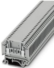
Durchgangsklemme, Nennspannung: 400 V, Nennstrom: 13,5 A, Anzahl der Anschlüsse: 2, Polzahl: 1, Anschlussart: Schraubanschluss, Bemessungsquerschnitt: 1 mm<sup>2</sup>, Querschnitt: 0,2 mm<sup>2</sup> - 4 mm<sup>2</sup>, Montageart: NS 35/7,5, NS 35/15, NS 32, Farbe: grau
