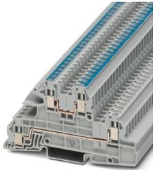
Installationsetagenklemme, Nennspannung: 400 V, Nennstrom: 24 A, Schraubanschluss, 1., 2. und 3. Etage, Bemessungsquerschnitt: 2,5 mm<sup>2</sup>, Querschnitt: 0,2 mm<sup>2</sup> - 4 mm<sup>2</sup>, Montageart: NS 35/7,5, NS 35/15, Farbe: grau
