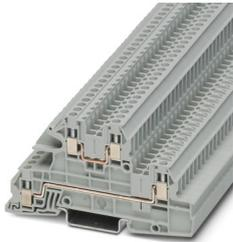
Installationsetagenklemme, Nennspannung: 400 V, Nennstrom: 24 A, Schraubanschluss, 1., 2. und 3. Etage, Bemessungsquerschnitt: 2,5 mm<sup>2</sup>, Querschnitt: 0,2 mm<sup>2</sup> - 4 mm<sup>2</sup>, Montageart: NS 35/7,5, NS 35/15, Farbe: grau
