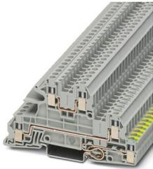
Installations-Schutzleiterklemme, Nennspannung: 400 V, Nennstrom: 24 A, Schraubanschluss, 1., 2. und 3. Etage, Bemessungsquerschnitt: 2,5 mm<sup>2</sup>, Querschnitt: 0,2 mm<sup>2</sup> - 4 mm<sup>2</sup>, Montageart: NS 35/7,5, NS 35/15, Farbe: grau
