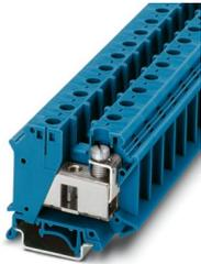
Installationsklemme, Nennspannung: 800 V, Nennstrom: 125 A, Schraubanschluss, Bemessungsquerschnitt: 35 mm<sup>2</sup>, Querschnitt: 0,75 mm<sup>2</sup> - 35 mm<sup>2</sup>, Montageart: NS 35/7,5, NS 35/15, Farbe: blau
