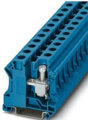
Installationsklemme, Nennspannung: 400 V, Nennstrom: 76 A, Schraubanschluss, 1. Etage Anschluss rechts, Bemessungsquerschnitt: 16 mm<sup>2</sup>, Querschnitt: 6 mm<sup>2</sup> - 25 mm<sup>2</sup>, Montageart: NS 35/7,5, NS 35/15, Farbe: blau
