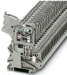
Sicherungsreihenkleme, Art der Sicherung: Glas / Keramik / ..., Sicherungstyp: G / 5 x 20, Nennspannung: 24 V, Nennstrom: 6,3 A, Polzahl: 1, Anschlussart: Schraubanschluss, Bemessungsquerschnitt: 4 mm<sup>2</sup>, Querschnitt: 0,14 mm<sup>2</sup>- 6 mm<sup>2</sup>, Montageart: NS 35/7,5, NS 35/15, Farbe: grau
