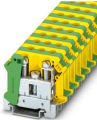
Installations-Schutzleiterklemme, Schraubanschluss, Bemessungsquerschnitt: 35 mm<sup>2</sup>, Querschnitt: 0,75 mm<sup>2</sup> - 35 mm<sup>2</sup>, Montageart: NS 35/7,5, NS 35/15, Farbe: grün-gelb
