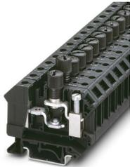
Sicherungsreihenklemme, Art der Sicherung: Glas / Keramik / ..., Sicherungstyp: G / 5 x 20, Nennspannung: 500 V, Nennstrom: 10 A, Anschlussart: Schraubanschluss, Bemessungsquerschnitt: 1,5 mm<sup>2</sup>, Querschnitt: 0,5 mm<sup>2</sup>- 16 mm<sup>2</sup>, Montageart: NS 35/7,5, NS 35/15, NS 32, Farbe: schwarz
