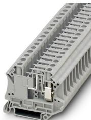
Trennklemme, Strom und Spannung werden durch den eingesetzten Stecker bestimmt., mit Prüfbuchsenschrauben zur Aufnahme von Prüfsteckern, Nennspannung: 500 V, Nennstrom: 20 A, Anschlussart: Schraubanschluss, Bemessungsquerschnitt: 2,5 mm<sup>2</sup>, Querschnitt: 0,2 mm<sup>2</sup> - 10 mm<sup>2</sup>, Montage: NS 35/7,5, NS 35/15, Farbe: grau
