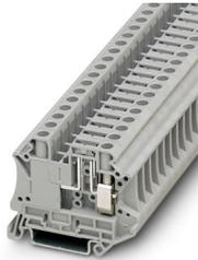
Trennklemme, Strom und Spannung werden durch den eingesetzten Stecker bestimmt., mit Prüfbuchschrauben zur Aufnahme von Prüfsteckern, Nennspannung: 500 V, Nennstrom: 20 A, Anschlussart: Schraubanschluss, Bemessungsquerschnitt: 6 mm<sup>2</sup>, Querschnitt: 0,2 mm<sup>2</sup> - 10 mm<sup>2</sup>, Montage: NS 35/7,5, NS 35/15, Farbe: grau
