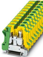
Installations-Schutzleiterklemme, Anzahl der Anschlüsse: 2, Polzahl: 1, Anschlussart: Schraubanschluss, 1. Etage Anschluss rechts, Bemessungsquerschnitt: 16 mm<sup>2</sup>, Querschnitt: 6 mm<sup>2</sup> - 25 mm<sup>2</sup>, Befestigungsart: PE-Fuß mit Befestigungsschraube, M4, Montageart: NS 35/7,5, NS 35/15, Farbe: grün-gelb
