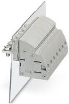
Durchführungsklemme, Anschlussart: Schraubanschluss mit Zughülse, Kabelschuhanschluss, Polzahl: 1, Belastungsstrom: 101 A, Querschnitt: 6 mm<sup>2</sup> - 35 mm<sup>2</sup>, Anschlussrichtung des Leiters zur Steckrichtung: -90 °, Breite: 15 mm, Farbe: grau
