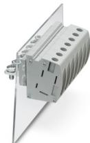
Durchführungsklemme, Anschlussart: Schraubanschluss mit Zughülse, Kabelschuhanschluss, Polzahl: 1, Belastungsstrom: 101 A, Querschnitt: 6 mm<sup>2</sup> - 35 mm<sup>2</sup>, Anschlussrichtung des Leiters zur Steckrichtung: 0 °, Breite: 15 mm, Farbe: grau
