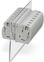
Durchführungsklemme, Anschlussart: Schraubanschluss mit Zughülse, Schraubanschluss mit Zughülse, Polzahl: 1, Belastungsstrom: 101 A, Querschnitt: 6 mm<sup>2</sup> - 35 mm<sup>2</sup>, Anschlussrichtung des Leiters zur Steckrichtung: 0 °, Breite: 15,1 mm, Farbe: grau
