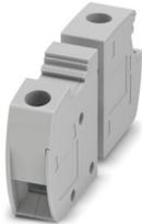
Durchführungsklemme, Anschlussart: Schraubanschluss mit Zughülse, Schraubanschluss mit Zughülse, Polzahl: 1, Belastungsstrom: 57 A, Querschnitt: 0,5 mm<sup>2</sup> - 16 mm<sup>2</sup>, Anschlussrichtung des Leiters zur Steckrichtung: 0 °, Breite: 10,1 mm, Farbe: grau
