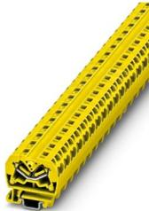
Minidurchgangsklemme, Nennspannung: 800 V, Nennstrom: 24 A, Anzahl der Anschlüsse: 4, Anschlussart: Zugfederanschluss, Bemessungsquerschnitt: 2,5 mm<sup>2</sup>, 1. Etage, Querschnitt: 0,08 mm<sup>2</sup> - 4 mm<sup>2</sup>, Montageart: NS 15, Farbe: gelb
