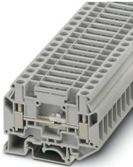
Trennklemme, Nennspannung: 500 V, Nennstrom: 41 A, Anschlussart: Schraubanschluss, 1. Etage, Bemessungsquerschnitt: 6 mm<sup>2</sup>, Querschnitt: 0,5 mm<sup>2</sup> - 10 mm<sup>2</sup>, Montageart: NS 35/7,5, NS 35/15, NS 32, Farbe: grau
