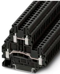
Doppelstockklemme, Nennspannung: 800 V, Nennstrom: 30 A, Anschlussart: Schraubanschluss, 1. und 2. Etage, Bemessungsquerschnitt: 4 mm<sup>2</sup>, Querschnitt: 0,14 mm<sup>2</sup> - 6 mm<sup>2</sup>, Montageart: NS 35/7,5, NS 35/15, Farbe: schwarz
