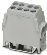
Hauptleitungs-Abzweigklemme, Nennspannung: 400 V, Nennstrom: 101 A, Anzahl der Anschlüsse: 4, Polzahl: 1, Anschlussart: Schraubanschluss, Bemessungsquerschnitt: 25 mm<sup>2</sup>, 1. Etage, Querschnitt: 1,5 mm<sup>2</sup> - 25 mm<sup>2</sup>, Schraubanschluss, 2. Etage, Querschnitt: 1,5 mm<sup>2</sup> - 16 mm<sup>2</sup>, Montageart: NS 35/7,5, NS 35/15, Farbe: grau
