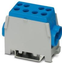
Hauptleitungs-Abzweigklemme, Nennspannung: 400 V, Nennstrom: 125 A, Anzahl der Anschlüsse: 4, Polzahl: 1, Anschlussart: Schraubanschluss, Bemessungsquerschnitt: 35 mm<sup>2</sup>, 1. Etage, Querschnitt: 10 mm<sup>2</sup> - 35 mm<sup>2</sup>, Schraubanschluss, 2. Etage, Querschnitt: 1,5 mm<sup>2</sup> - 25 mm<sup>2</sup>, Montageart: NS 35/7,5, NS 35/15, Farbe: blau
