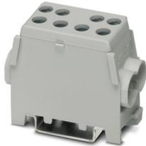
Hauptleitungs-Abzweigklemme, Nennspannung: 400 V, Nennstrom: 125 A, Anzahl der Anschlüsse: 4, Polzahl: 1, Anschlussart: Schraubanschluss, Bemessungsquerschnitt: 35 mm<sup>2</sup>, 1. Etage, Querschnitt: 10 mm<sup>2</sup> - 35 mm<sup>2</sup>, Schraubanschluss, 2. Etage, Querschnitt: 1,5 mm<sup>2</sup> - 25 mm<sup>2</sup>, Montageart: NS 35/7,5, NS 35/15, Farbe: grau
