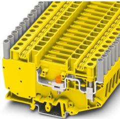
Messwandler-Trennklemme, mit Gleitsteg, Nennspannung: 500 V, Nennstrom: 41 A, Anschlussart: Schraubanschluss, 1. Etage, Bemessungsquerschnitt: 6 mm<sup>2</sup>, Querschnitt: 0,5 mm<sup>2</sup> - 10 mm<sup>2</sup>, Montageart: NS 35/7,5, NS 35/15, NS 32, Farbe: gelb
