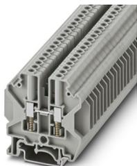
Durchgangsklemme, Nennspannung: 1000 V, Nennstrom: 32 A, Anzahl der Anschlüsse: 2, Anschlussart: Schraubanschluss mit Federunterstützung, Bemessungsquerschnitt: 4 mm<sup>2</sup>, 1. Etage, Querschnitt: 0,2 mm<sup>2</sup> - 6 mm<sup>2</sup>, Montageart: NS 35/7,5, NS 35/15, NS 32, Farbe: grau
