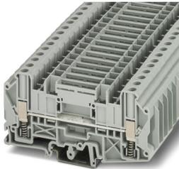
Durchgangsklemme, mit Federunterstützung, Nennspannung: 1000 V, Nennstrom: 41 A, Anschlussart: Schraubanschluss mit Federunterstützung, 1. Etage, Bemessungsquerschnitt: 6 mm<sup>2</sup>, Querschnitt: 0,2 mm<sup>2</sup> - 10 mm<sup>2</sup>, Montageart: NS 35/7,5, NS 35/15, NS 32, Farbe: grau
