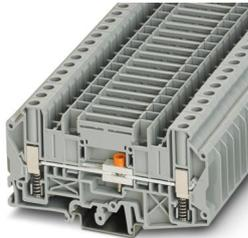
Trennklemme, mit Federunterstützung, Nennspannung: 1000 V, Nennstrom: 41 A, Anschlussart: Schraubanschluss, 1. Etage, Bemessungsquerschnitt: 6 mm<sup>2</sup>, Querschnitt: 0,2 mm<sup>2</sup> - 10 mm<sup>2</sup>, Montageart: NS 35/7,5, NS 35/15, NS 32, Farbe: grau
