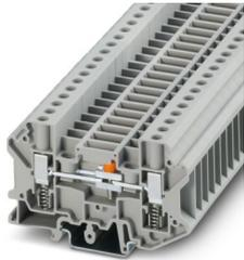
Messwandler-Trennklemme, Nennspannung: 500 V, Nennstrom: 41 A, Anschlussart: Schraubanschluss mit Federunterstützung, 1. Etage, Bemessungsquerschnitt: 6 mm<sup>2</sup>, Querschnitt: 0,2 mm<sup>2</sup> - 10 mm<sup>2</sup>, Montageart: NS 35/7,5, NS 35/15, NS 32, Farbe: grau
