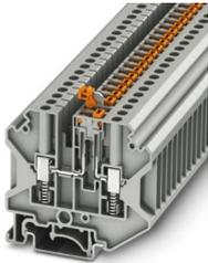
Messertrennklemme, Nennspannung: 500 V, Nennstrom: 20 A, 1. Etage, Anschlussart: Schraubanschluss mit Federunterstützung, Bemessungsquerschnitt: 4 mm<sup>2</sup>, Querschnitt: 0,2 mm<sup>2</sup> - 6 mm<sup>2</sup>, Montage: NS 35/7,5, NS 35/15, NS 32, Farbe: grau
