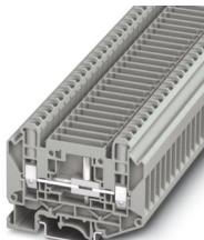
Messwandler-Trennklemme, mit Prüfbuchsenschrauben zur Aufnahme von Prüfsteckern, Nennspannung: 1000 V, Nennstrom: 41 A, Anschlussart: Schraubanschluss, 1. Etage, Bemessungsquerschnitt: 6 mm<sup>2</sup>, Querschnitt: 0,2 mm<sup>2</sup> - 10 mm<sup>2</sup>, Montageart: NS 35/7,5, NS 35/15, NS 32, Farbe: grau
