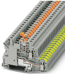
Schutzleiter-Reihenklemme, Nennspannung: 500 V, Nennstrom: 20 A, Anschlussart: Schraubanschluss, Bemessungsquerschnitt: 2,5 mm<sup>2</sup>, Querschnitt: 0,14 mm<sup>2</sup> - 6 mm<sup>2</sup>, Montage: NS 35/7,5, NS 35/15, Farbe: grau
