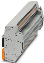
Prüfsteckleiste, Nennspannung: 400 V, Anzahl der Anschlüsse: 40, Polzahl: 20, Anschlussart: Push-in-Anschluss, Bemessungsquerschnitt: 6 mm<sup>2</sup>, 1. Etage, Querschnitt: 0,5 mm<sup>2</sup> - 10 mm<sup>2</sup>, Montageart: NS 35/7,5, NS 35/7,5, Farbe: grau
