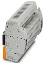
Prüfsteckleiste, Nennspannung: 400 V, Anzahl der Anschlüsse: 22, Polzahl: 11, Anschlussart: Schraubanschluss, Bemessungsquerschnitt: 6 mm<sup>2</sup>, 1. Etage, Querschnitt: 0,2 mm<sup>2</sup> - 10 mm<sup>2</sup>, Montageart: Tragschienenmontage, Farbe: grau
