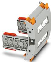
Blindstecker, VDE kodiert Typ B7, Rastermaß: 8,2 mm, Breite: 71 mm, Höhe: 81 mm, Polzahl: 7, Farbe: grau, Montageart: Stecken in die Grundleiste
