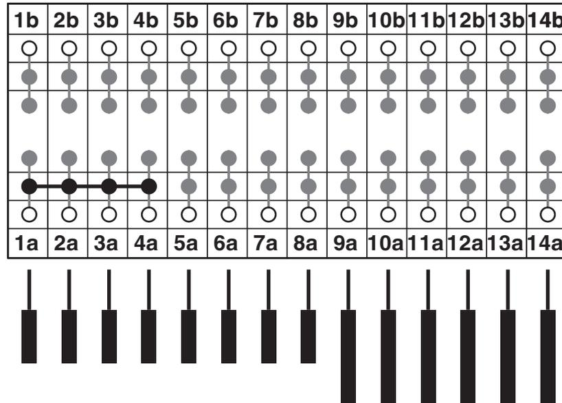
Schaltbild zeigt Prüfsteckleiste mit eingestecktem Prüfstecker
