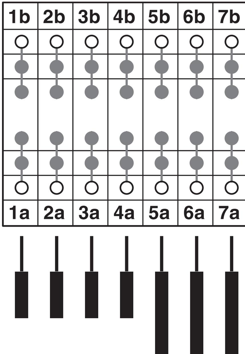
Schaltbild zeigt Prüfsteckleiste mit eingestecktem Prüfstecker
