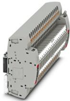
Prüfsteckleiste, VDE kodiert Typ H19, Nennspannung: 400 V, Anzahl der Anschlüsse: 38, Polzahl: 19, Anschlussart: Push-in-Anschluss, Bemessungsquerschnitt: 6 mm<sup>2</sup>, 1. Etage, Querschnitt: 0,5 mm<sup>2</sup> - 10 mm<sup>2</sup>, Montageart: NS 35/7,5, NS 35/15, Farbe: grau
