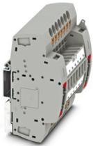
Prüfsteckleiste, VDE kodiert Typ A7, Nennspannung: 400 V, Nennstrom: 24 A, Anzahl der Anschlüsse: 14, Polzahl: 7, Anschlussart: Push-in-Anschluss, Bemessungsquerschnitt: 6 mm<sup>2</sup>, 1. Etage, Querschnitt: 0,5 mm<sup>2</sup> - 10 mm<sup>2</sup>, Montageart: Tragschienenmontage, NS 35/7,5, NS 35/15, Farbe: grau
