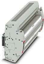
Prüfsteckleiste, VDE kodiert Typ D19, Nennspannung: 400 V, Anzahl der Anschlüsse: 38, Polzahl: 19, Anschlussart: Schraubanschluss, Bemessungsquerschnitt: 6 mm<sup>2</sup>, 1. Etage, Querschnitt: 0,2 mm<sup>2</sup> - 10 mm<sup>2</sup>, Montageart: NS 35/7,5, NS 35/15, Farbe: grau
