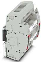
Prüfsteckleiste, VDE kodiert Typ A7, Nennspannung: 400 V, Nennstrom: 24 A, Anzahl der Anschlüsse: 14, Polzahl: 7, Anschlussart: Schraubanschluss, Bemessungsquerschnitt: 6 mm<sup>2</sup>, 1. Etage, Querschnitt: 0,2 mm<sup>2</sup> - 10 mm<sup>2</sup>, Montageart: TragschieneMontage, NS 35/7,5, NS 35/15, Farbe: grau
