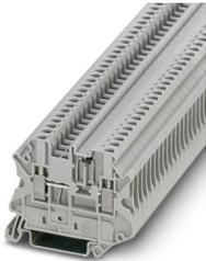
Bauelementreihenklemme, mit integrierter Diode 1N4007, Nennstrom: 0,5 A, Anzahl der Anschlüsse: 2, Anschlussart: Schraubanschluss, Bemessungsquerschnitt: 2,5 mm<sup>2</sup>, Querschnitt: 0,14 mm<sup>2</sup> - 4 mm<sup>2</sup>, Montageart: NS 35/7,5, NS 35/15, Farbe: grau
