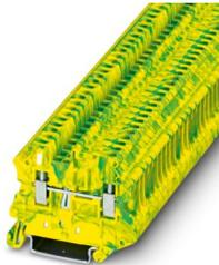
Schutzleiter-Reihenklemme, Anzahl der Anschlüsse: 2, Anschlussart: Schraubanschluss, Querschnitt:  $0,14 \text{ mm}^2 - 4 \text{ mm}^2$ , Montageart: NS 35/7,5, NS 35/15, Farbe: grün-gelb
