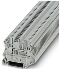
Durchgangsklemme, Nennspannung: 800 V, Nennstrom: 24 A, Anzahl der Anschlüsse: 2, Polzahl: 1, Anschlussart: Schraubanschluss, Bemessungsquerschnitt: 2,5 mm<sup>2</sup>, Querschnitt: 0,14 mm<sup>2</sup> - 4 mm<sup>2</sup>, Montageart: NS 35/7,5, NS 35/15, Farbe: grau
