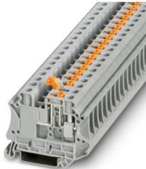
Messertrennklemme, mit Prüfbuchsen-schrauben zur Aufnahme von Prüfsteckern, Nennspannung: 500 V, Thermischer Dauerstrom  $I_{th}$ : 20 A, Anschlussart: Schraubanschluss, Bemessungsquerschnitt: 6 mm<sup>2</sup>, Querschnitt: 0,2 mm<sup>2</sup> - 10 mm<sup>2</sup>, Montage: NS 35/7,5, NS 35/15, Farbe: grau
