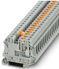
Messertrennklemme, Nennspannung: 500 V, Thermischer Dauerstrom  $I_{th}$ : 20 A, Anschlussart: Schraubanschluss, Bemessungsquerschnitt: 6 mm<sup>2</sup>, Querschnitt: 0,2 mm<sup>2</sup> - 10 mm<sup>2</sup>, Montage: NS 35/7,5, NS 35/15, Farbe: grau
