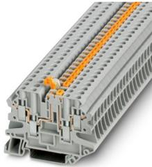
Messertrennklemme, Nennspannung: 500 V, Nennstrom: 20 A, Anzahl der Anschlüsse: 4, Anschlussart: Schraubanschluss, Bemessungsquerschnitt: 2,5 mm<sup>2</sup>, Querschnitt: 0,14 mm<sup>2</sup> - 6 mm<sup>2</sup>, Montageart: NS 35/7,5, NS 35/15, Farbe: grau
