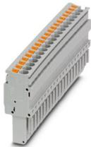
Stecker, Nennspannung: 500 V, Nennstrom: 24 A, Anzahl der Anschlüsse: 20, Polzahl: 20, Anschlussart: Push-in-Anschluss, Bemessungsquerschnitt: 2,5 mm<sup>2</sup>, 1. Etage, Querschnitt: 0,14 mm<sup>2</sup> - 4 mm<sup>2</sup>, Farbe: grau
