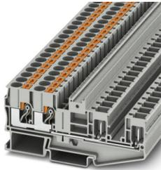
Durchgangsklemme, Nennspannung: 1000 V, Nennstrom: 41 A, Anzahl der Anschlüsse: 4, Anschlussart: Push-in- / Steckanschluss, Bemessungsquerschnitt: 6 mm<sup>2</sup>, Querschnitt: 0,5 mm<sup>2</sup> - 10 mm<sup>2</sup>, Montageart: NS 35/7,5, NS 35/15, Farbe: grau
